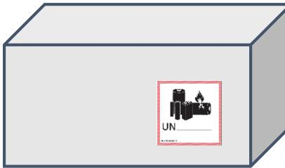
**■梱包例3【Section II (組電池が2個以下で、運送状1件あたり、当該包装物の個数が2個を超えない場合)】**
